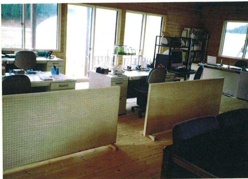
「有孔ベニヤの下はラピパネル」 「湿度は50～70%を維持し、吸音性能も高い」
